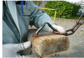
金具摩耗と座板の腐朽
