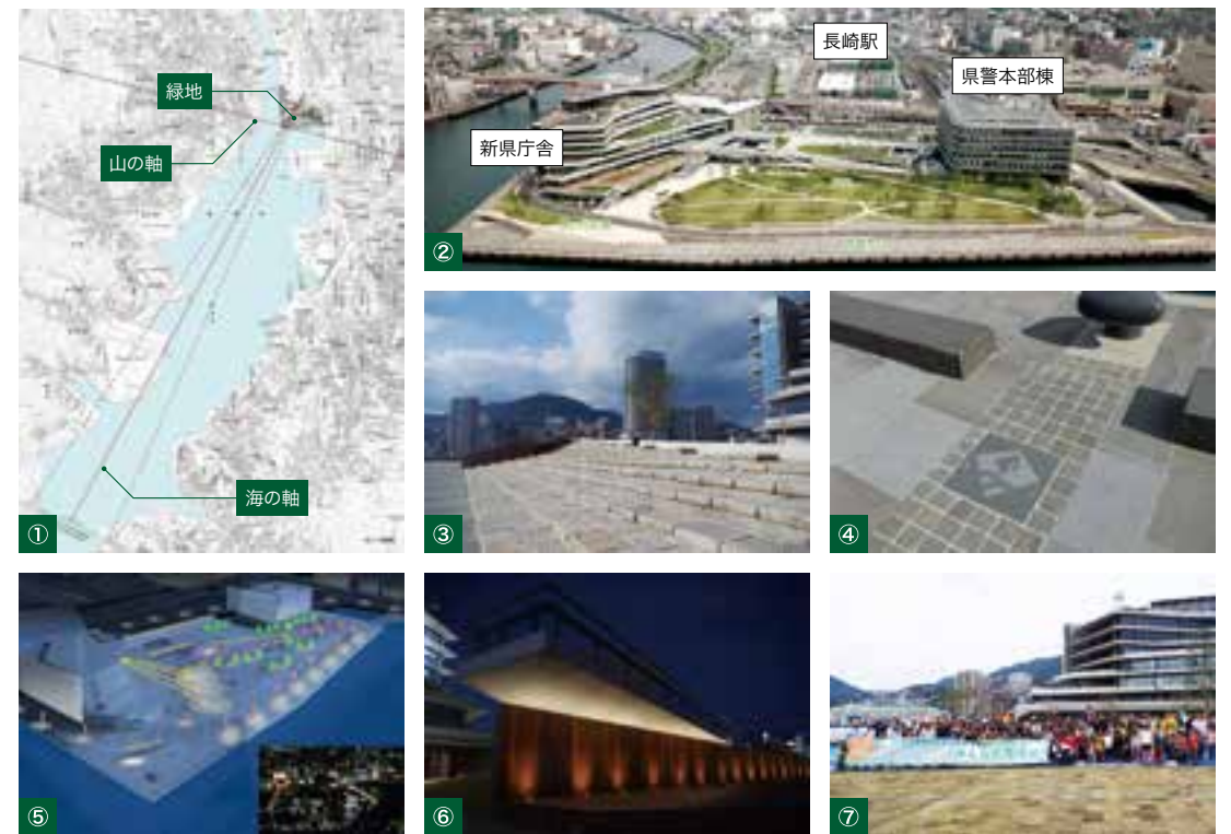
①港の軸と山の軸 ②新長崎県庁舎と新長崎県警本部棟と海に挟まれた立地 ③漁港時代の舗石を再利用した大階段 ④県産石材の阿翁石に、伝統行事の「ハタ」の意匠を刻んだアクセント ⑤夜景と昼景の両立を目指した照明計画 ⑥山の軸を可視化させた展望デッキ ⑦市民とともに取り組んだ「芝はり」イベント
