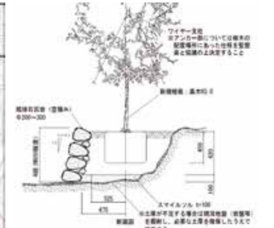
植栽設計図(例: 岩角地のため植栽柵の土厚を確保する手法で設計)
